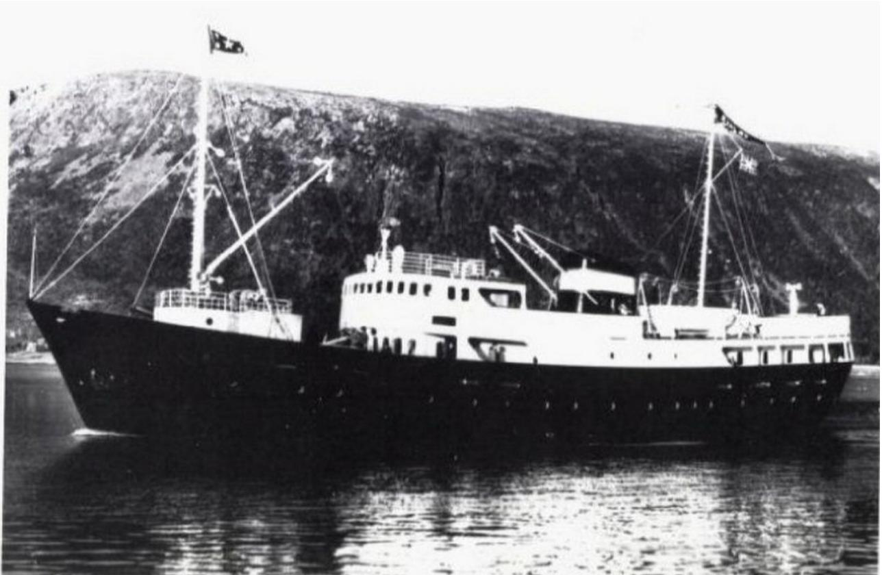
B.No.78: KVALØY. Ble sjøsatt og døpt Mandag 22. August. 1955. Til A/S Troms Fylkes Dampskipsselskab, som kombinert tørrlast og passasjerbåt. 46,3 meter lang, 8,7 meter bred.
