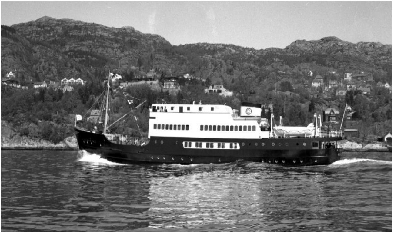
B.No:70. KVINNHERAD. Sjøsatt 22. September 1949. Passasjerbåt til HSD. Det var sertifisert for 380 passasjerer, 46 meter langt, 8 meter bredt og brutto vekt på 498 Tonn.
