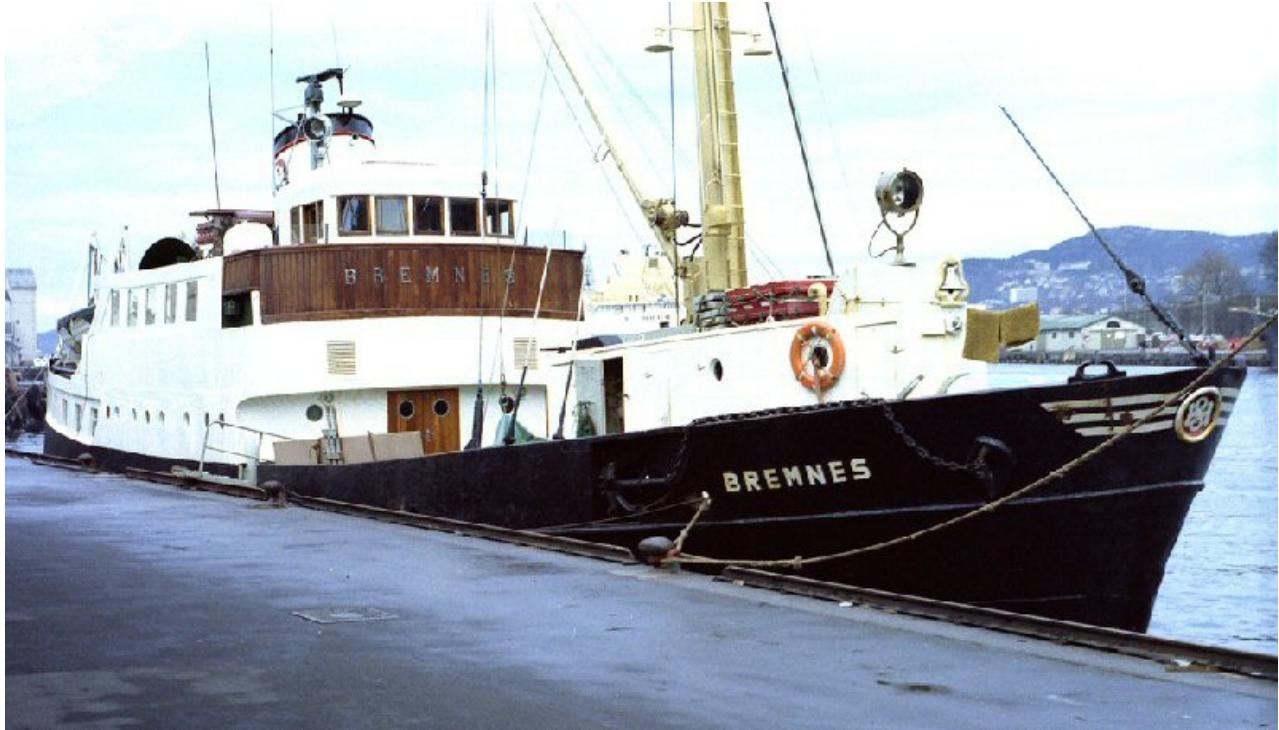
B.No:69. BREMNES. Sjøsatt 18. Juni 1948 som første stabelavløpning etter krigen. Levert Mars 1949. Passasjerbåt til HSD. 33 meter lang, 6,8 meter bred og 238 bruttotonn. Kapasitet til 250 reisende og 100 tonn last. 40 køyplasser. Motor på 400 Hp fra Crossley Bros. Ltd. UK.
