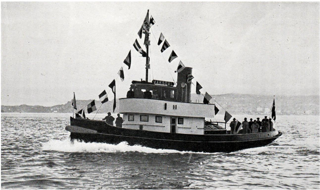
B.No:65. VAKSDAL. Slepebåt til Vaksdal mølle. Overlevert 25 September 1936. Båten er 20,3 meter lang, 5,5 meter bred og 70 bruttotonn. Har en 250 hk Unionmotor levert av "De forenede motorfabrikker" på Damsgård. På prøveturen oppnådde den en fart på 10,5 mil.
