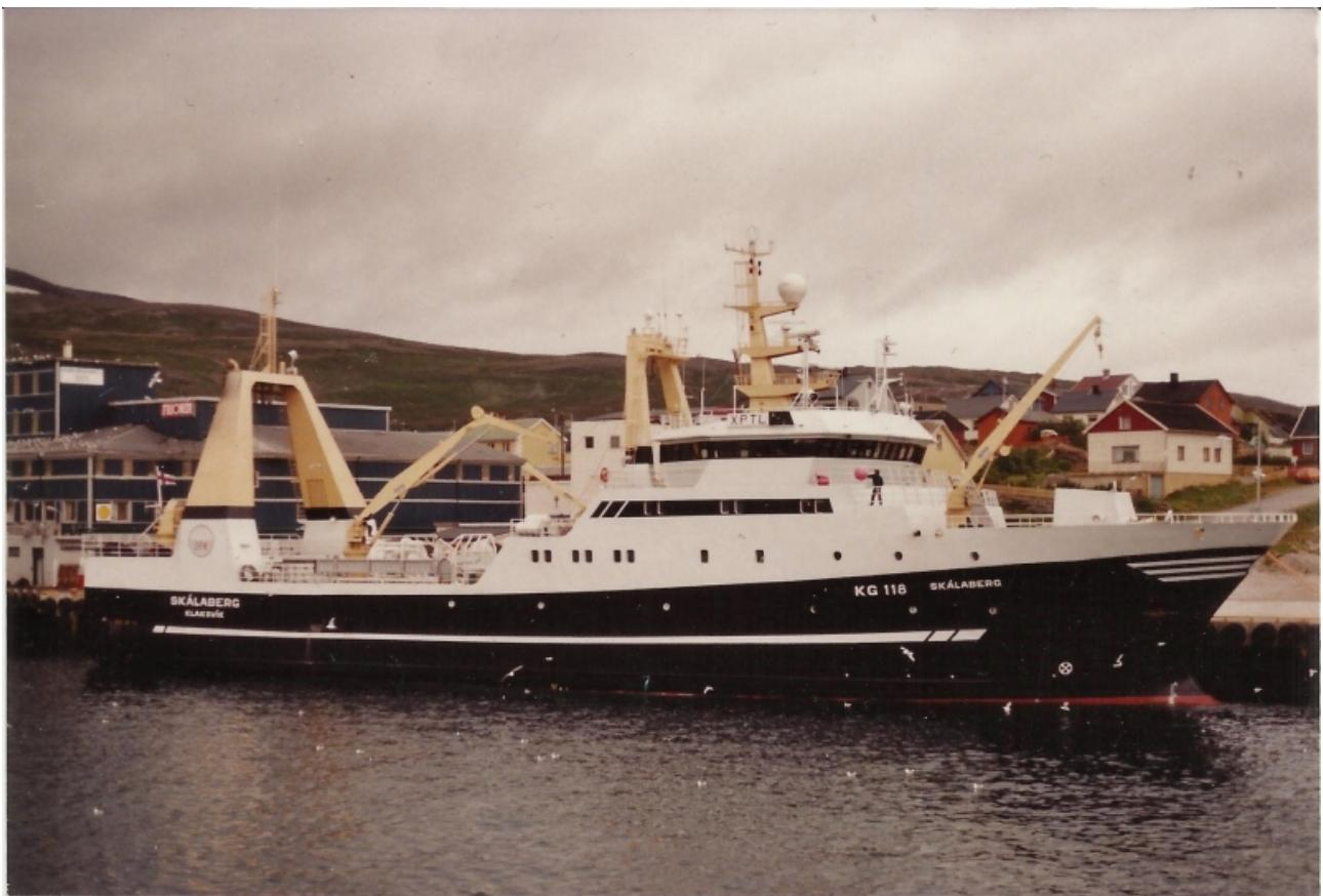
B.No.140: SKALABERG, Fabrikktråler til P/J. J.F. Kjølbro, Klaksvik, Færøyene. Skrog bygget i Sverige av Bruce SY i Landskrona. Utrustet av M+K og døpt 18. Februar 1989. Lengde 67 meter, bredde 13,8 meter. Hovedmotor fra Wichmann på 4890 bhp. Omdøpt i 2000 til POLAR PRINCESS. Nåværende eier: NORTHERN KURILY SEINER FLEET - SEVERO KURILSK, Russian Federation. Den heter nå: OSTROV MONERON.
