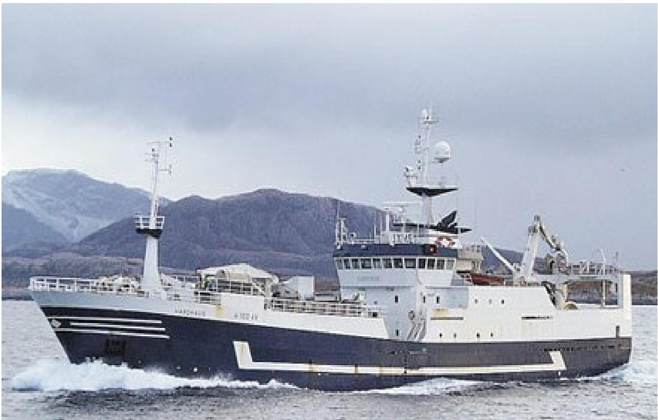
B.Nr. 137: HARDHAUS. Fabrikktråler til Inge Møgster, Bekkjarvik. Overlevert 10 Januar 1987. Lengde 65 meter, bredde 12,60 meter og 1880 bruttotonn. Hovedmotor fra Wichmann på 4080 bhp som gir en fart på 15,5 knop. Båten var utsatt for brann i maskinrommet på prøveturen og en mann omkom på sykehuset. Mars 2003: Omdøpt HARDHAUS II.
