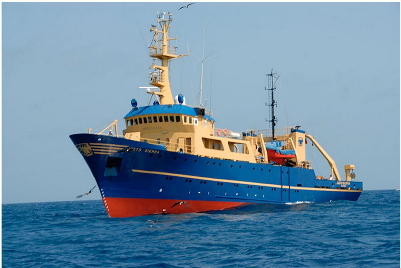
B.No. 130: JUSTO SIERRA, forskningsskip til Universitetet i Mexico. Søsterskip til B.Nr.129: El Puma. 50 meter langt, 10 meter bredt og 780 bruttotonn. 1700 bhp hovedmotor som gir en fart av 14,3 knop. Overlert 15 juli 1982.
