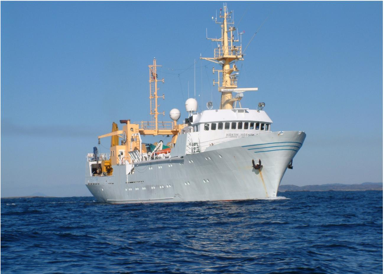
B.No.128: HÅKON MOSBY Sjøsett 18. April, overlevert 11. September 1980. Forskningskip til Universitetet i Bergen. Lengde 47,24 meter, bredde 10,32 meter og 497 bruttotonn. Hovedmotor fra Normo på 1500 bhk. Forskningsfartøyet var beregnet til å koste i underkant av 24 millioner nytt. Båten ble solgt i 2017 fra Havforskningsinstituttet for 1.65 mil. kr. til Arild Andre Ludvigsen A/S. Vidresolgt for 2,8 mil. kr. til Fisktrans A/S. I 2018 lå skipet for salg for 9 mil. kr.
